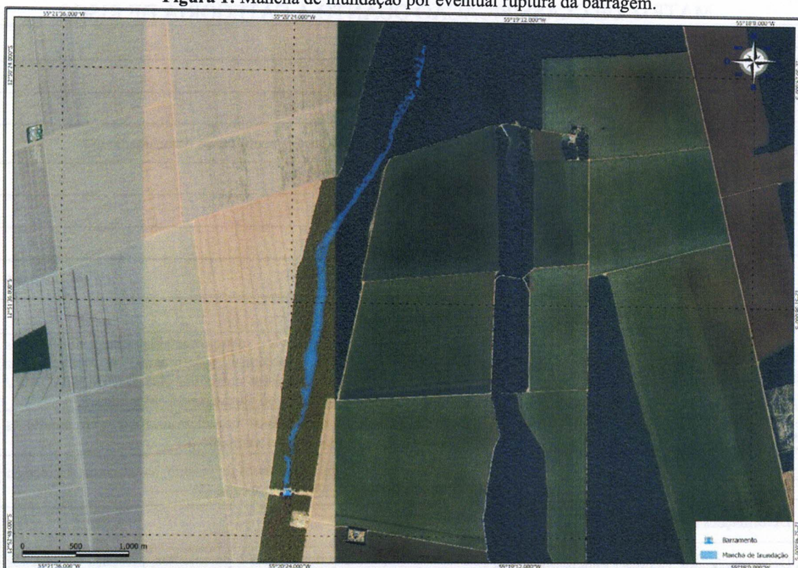
Figura 1: Mancha de inundação por eventual ruptura da barragem.
